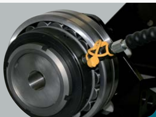
Снятие закрепительной втулки с помощью гидравлической гайки
